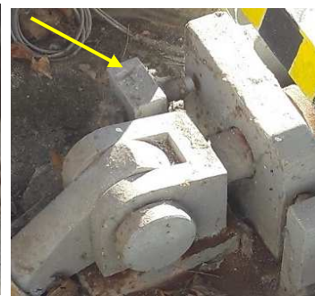
Obr.3 Ohnutá opěrná patka
