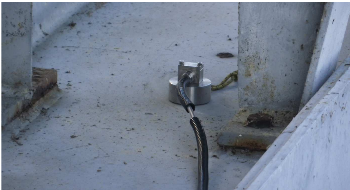
Obr. 13 Umístění snímače č. 2 na hlavním nosníku levé vrátně
